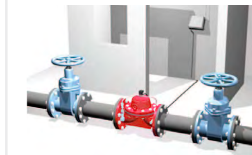
Válvula con solenoide de Dorot, controlada por un controlador local.
