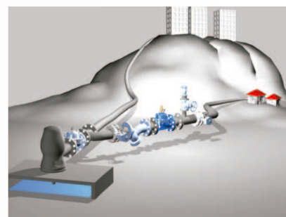
La válvula reductora de presión de Dorot reduce el suministro de presión variable estabilizada de aguas abajo.
