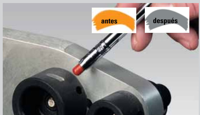
Control de temperatura con el lápiz indicador*
