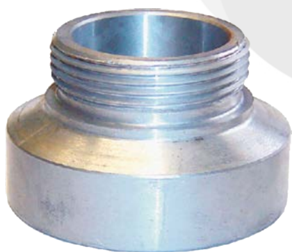
Casquillo reductor fabricado en aluminio estampado con rosca interior hembra de 2" a rosca exterior macho de 1 1/2".
