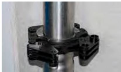
Apriete uniforme del empalme y deformación del elemento de junta mediante técnica de cuatro segmentos.
