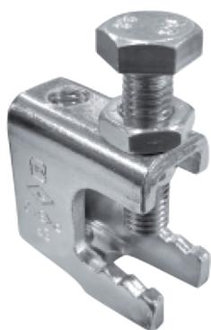
Mordaza metálica diseñada para fijar instalaciones aéreas sobre vigas metálicas sin necesidad de soldar ni de taladrar. La mordaza se compone de dos piezas. Una chapa metálica plegada en forma de "U" que lleva dos taladros roscados. En uno de ellos se alojará el tornillo de fijación a la viga y en el otro se roscará la varilla de donde posteriormente se colocará la instalación aérea.
