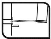
En caso de materiales huecos no emplear el percutor ni el martillo para evitar ocasionar daños en el interior del material base. Reducir la velocidad del taladro cuando se sospeche que la salida de la broca se encuentra próxima al interior hueco del material base.
