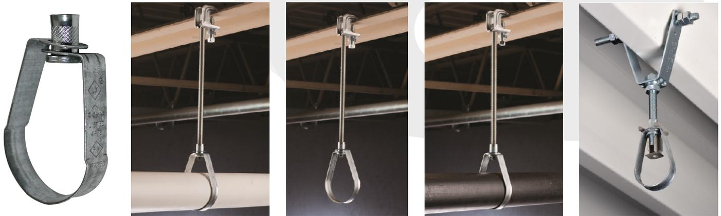
El colgador pera modelo FCN es ideal para la suspensión estacionaria y líneas de tubos con aislamiento, incluyendo tubos de CPVC, en sistema de rociadores contra incendios. La tuerca de inserción estriada ayuda a simplificar los ajustes verticales y los bordes brillantes en la base (diámetros de 12,7 mm a 101,6 mm [1/2" a 4"]) ayudan a proteger los tubos para evitar el contacto con algún borde filoso del colgador.
