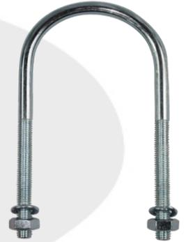
Los abarcones se utilizan para el soporte y guiado de tuberías tanto horizontales como verticales, así como soporte de punto fijo o soporte guía. Se suministra con dos tuercas hexagonales y dos arandelas sin montar.
